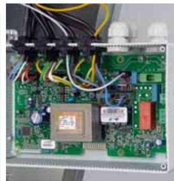
Scheda elettronica con microprocessore
