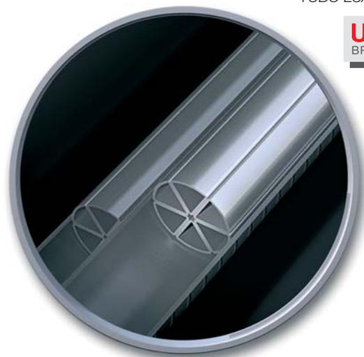
Questo permette di interbloccare tutta la struttura e creare le superfici volute per la trasmissione per conduzione (contatto tra le varie facce metalliche e l’acqua). Nella parte esposta all’acqua viene creata una serie di nervature a forma di vite che aumentando la superficie di scambio permettono la cessione veloce di calore all’acqua.
