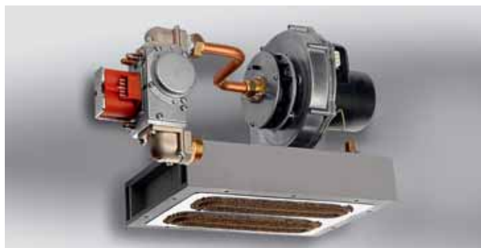
Gruppo di combustione premix a CO 2 costante (valvola gas modulante, ventilatore modulante e combustore in acciaio INOX)
