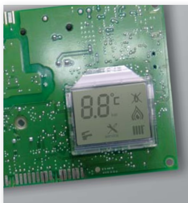
Scheda elettronica Utical HONEYWELL con microprocessore
