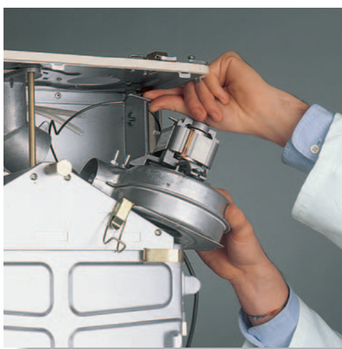
Smontaggio frontale del ventilatore con sgancio rapido
