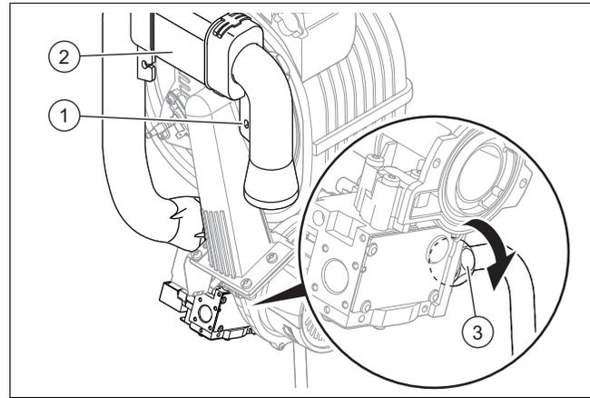
5. Svitare la vite di arresto (1) e rimuovere il tubo di aspirazione dell'aria (2) dal bocchettone di aspirazione.
