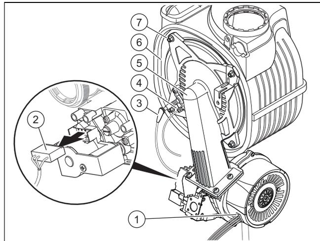
1. Innestare il modulo termico compatto (5) sullo scambiatore di calore (6).
