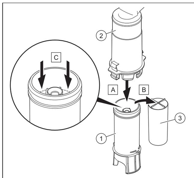
1. Sganciare la parte inferiore del sifone (1) da quella superiore (2) senza smontare il rivestimento anteriore del prodotto.
