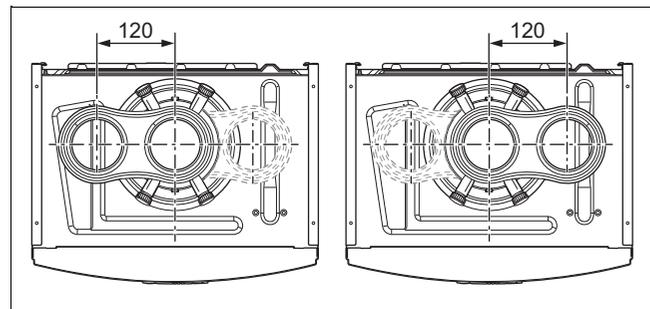
2. Inserire l'elemento di raccordo alternativo. Il collegamento per l'adduzione d'aria può essere rivolto verso sinistra o destra. Fare attenzione ai naselli.
