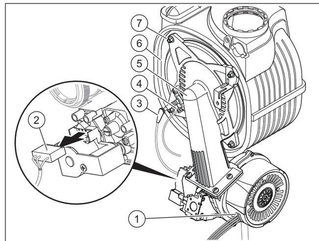
7. Staccare il connettore della linea di accensione (3) e del cavo di messa a terra (4) dall'elettrodo accensione.
