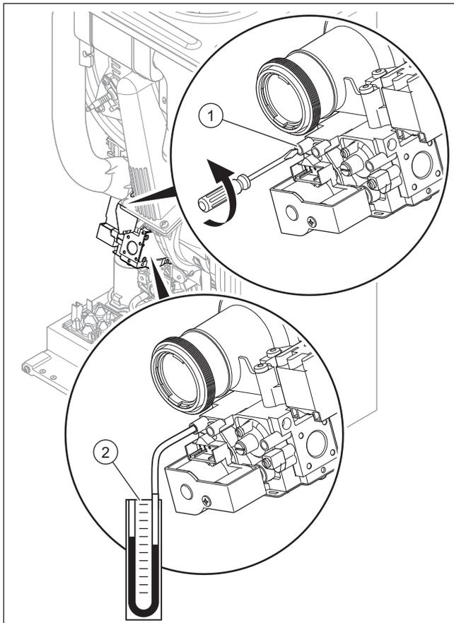
2. Con un cacciavite allentare la vite di tenuta sul raccordo di misurazione (1) della valvola del gas.
