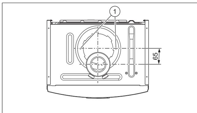
2. Procedendo verso il lato anteriore, inserire l'elemento di raccordo alternativo con spostamento.
