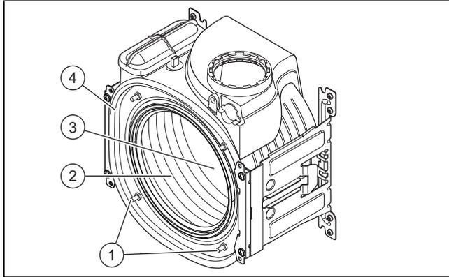
2. Non allentare i 4 dadi delle spine filettate (1) per garantire la tenuta del bruciatore durante il montaggio.
