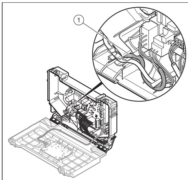
6. Osservare il percorso del cavo di allacciamento alla rete elettrica (1) nell'alloggiamento della scheda comando per garantire lo scarico della trazione.
