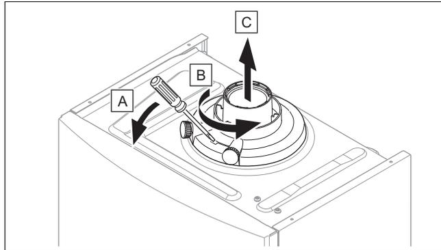
1. Inserire un giravite nella fessura tra i punti di misurazione.
