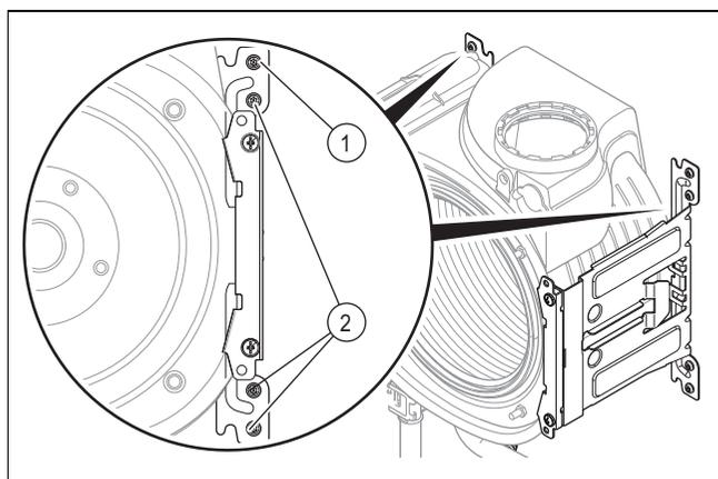
8. Rimuovere le tre viti inferiori (2) nella parte inferiore del supporto.
