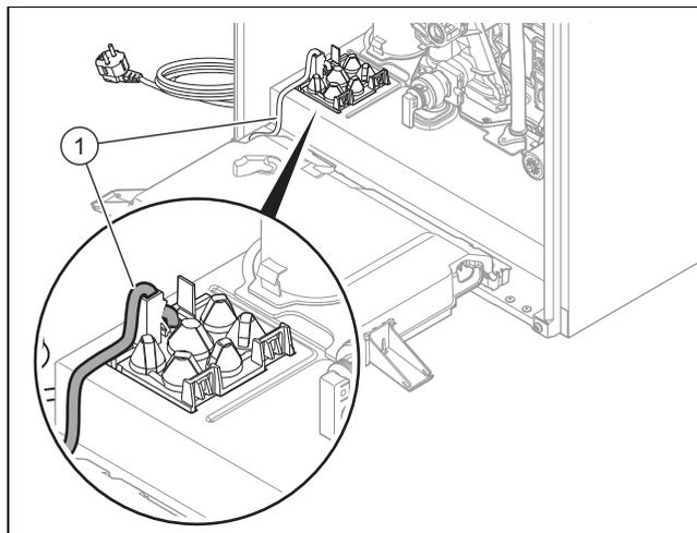
3. Posare un cavo di allacciamento alla rete elettrica a norma a tre treccie attraverso il passacavo nel prodotto.
