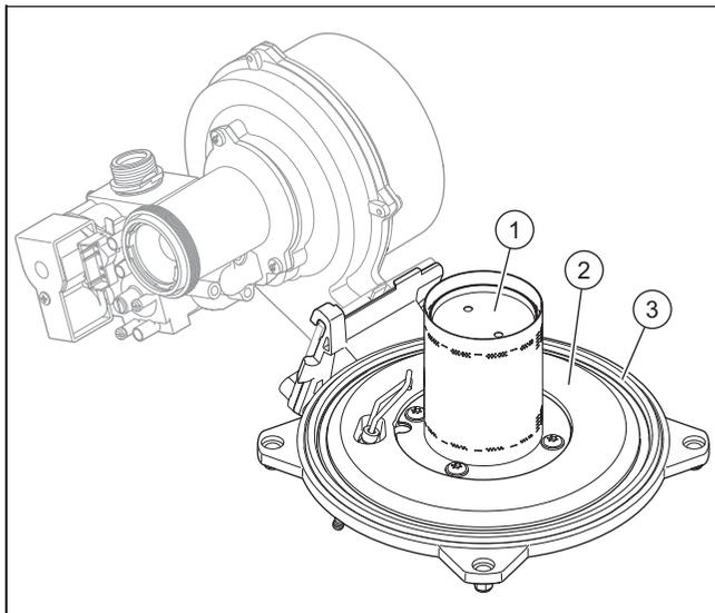
1. Controllare se la superficie del bruciatore (1) presenta eventuali danni. In caso positivo, sostituire il bruciatore.
