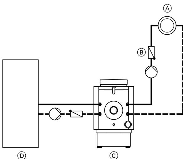
L'installazione di una valvola di ritegno nella mandata riscaldamento consente di evitare una circolazione naturale e incontrollata di calore nel sistema di riscaldamento, durante la produzione d'acqua calda sanitaria con dispositivo di precedenza o durante il funzionamento estivo.
