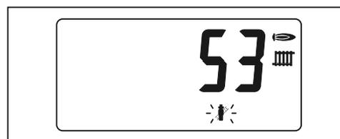
All'interno di questi 2 minuti, è possibile entrare nel livello Installatore, ruotando la manopola. Questo permette di eseguire interrogazioni nel livello Info sui valori dell'impianto in relazione alla corrispondente potenzialità.
