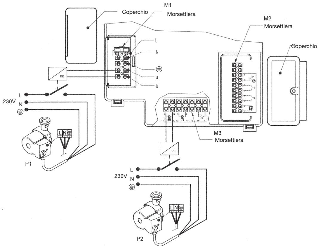
**P1 = Pompa separatore idraulico**
