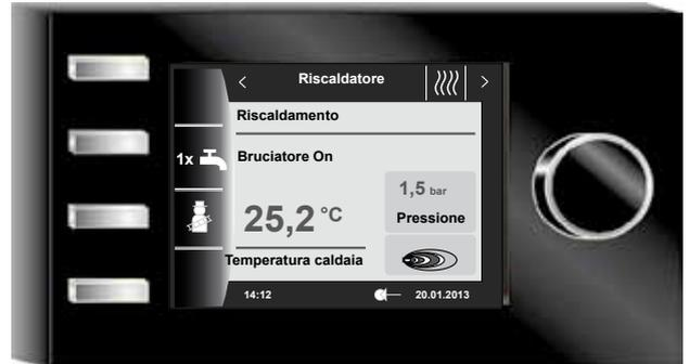
Il modulo BM-2 (modulo di comando) comunica con tutti i moduli di espansione e con la caldaia tramite eBus.
