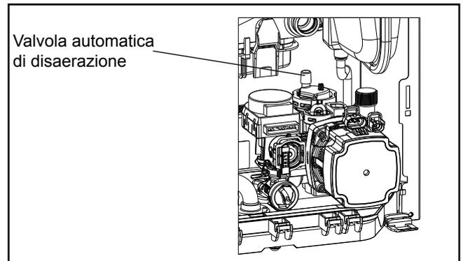
Figura: Valvola automatica di disaerazione nella pompa del circuito di riscaldamento
