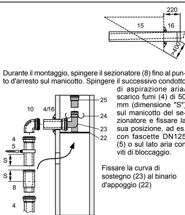
Durante il montaggio, spingere il sezionatore (8) fino al punto d'arresto sul manicotto. Spingere il successivo condotto di aspirazione aria/scarico fumi (4) di 50 mm (dimensione "S") sul manicotto del sezionatore e fissare la sua posizione, ad es. con fascette DN125 (5) o sul lato aria con viti di bloccaggio.
