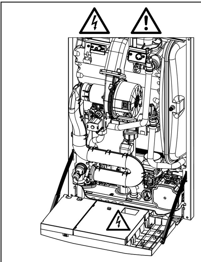
Figura: Trasformatore di accensione, elettrodo di accensione ad alta tensione, camera di combustione, valvola di commutazione V3V, pompa e ventilatore. Pericolo dovuto a tensione elettrica e di accensione, pericolo di ustioni per la presenza di componenti caldi
