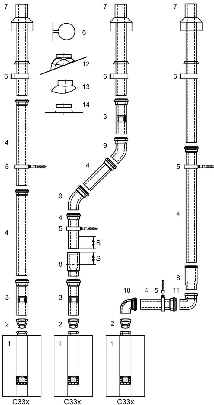
**Tipo C33x:** Caldaie a condensazione con condotto aspirazione aria comburente/ scarico fumi verticale a tetto.
