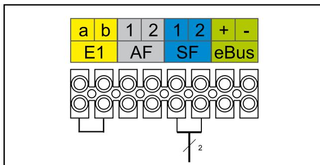
Figura: Collegamento del sensore accumulatore
