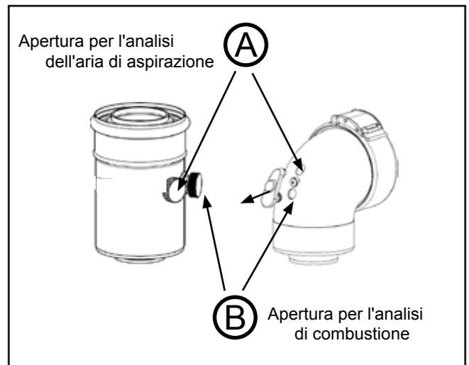
Figura: Analisi dell'aria di aspirazione e dei parametri fumi del sistema di scarico fumi 60/100 per le esecuzioni opzionali
