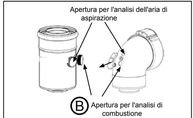
Figura: Analisi dell'aria di aspirazione e dei fumi del sistema di scarico fumi 60/100 per le esecuzioni opzionali
