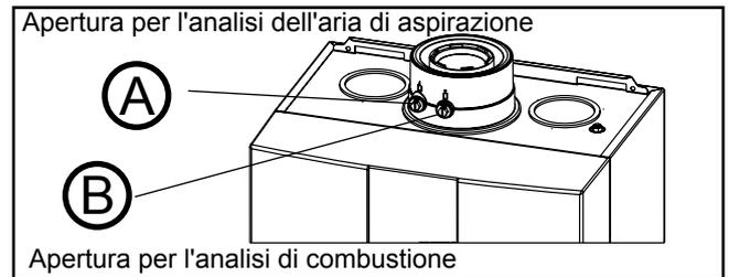
Figura: Analisi dei parametri dei fumi
