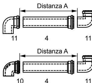
Determinare la distanza A. Il condotto di aspirazione aria/scarico fumi (4) deve sempre essere di ca. 100 mm più lungo della distanza A. Accorciare il condotto fumi sempre sul lato liscio, **non** sulla parte del manicotto.
