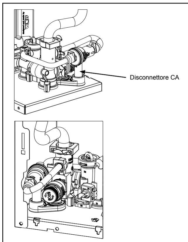
Figura: Dispositivo di carico con disconnettore
