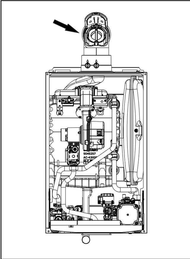
Figura: Sifone - riempimento attraverso il condotto di scarico fumi
