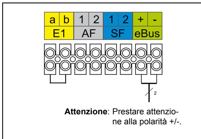
Figura: collegamento degli accessori digitali di termoregolazione (interfaccia eBus)
