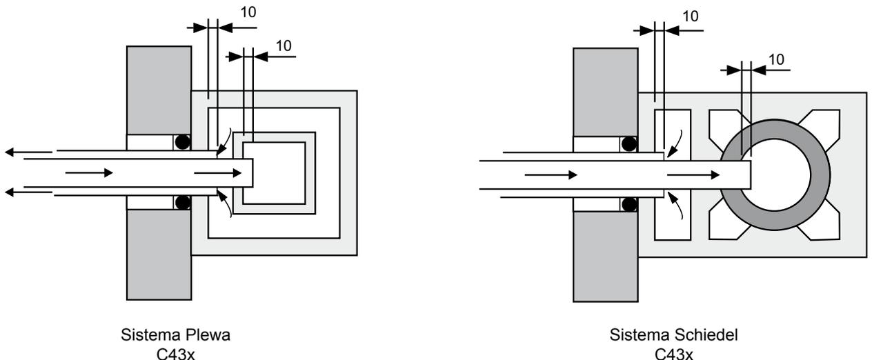
Sistema di aspirazione aria/scarico fumi intubato con condotto di collegamento orizzontale DN60/100
