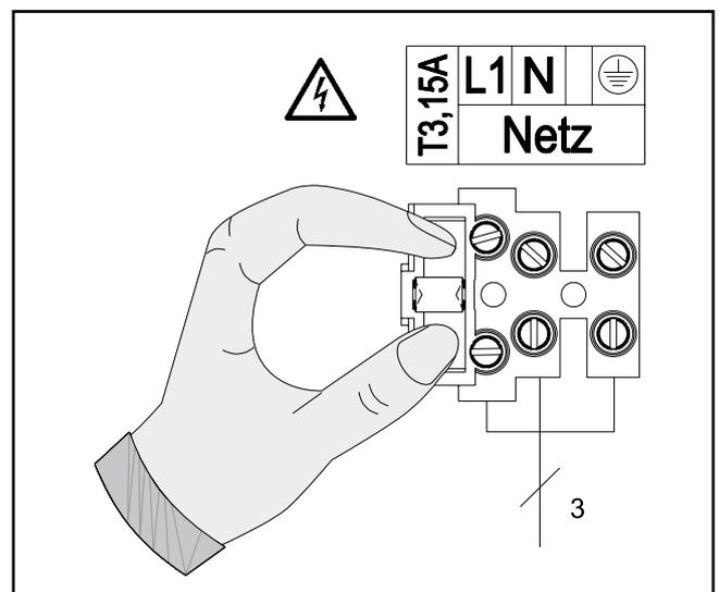
Figura: Sostituzione del fusibile
