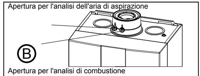
Figura: Aperture di misurazione
