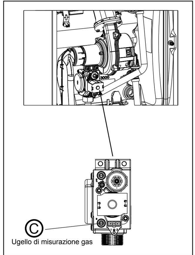
Figura: Conversione del tipo di gas
