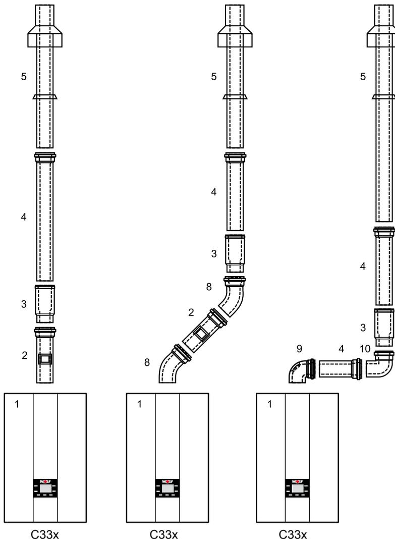
Esempi di realizzazione delle possibilità di collegamento con funzionamento indipendente dall'aria ambiente (verticali)
