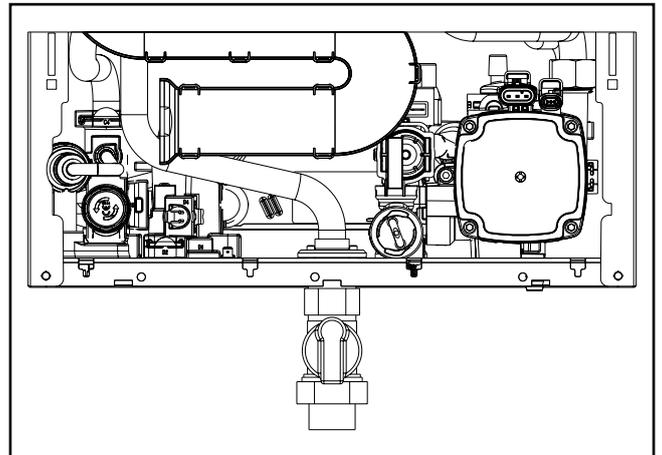
Figura: Montaggio dell'attacco gas
