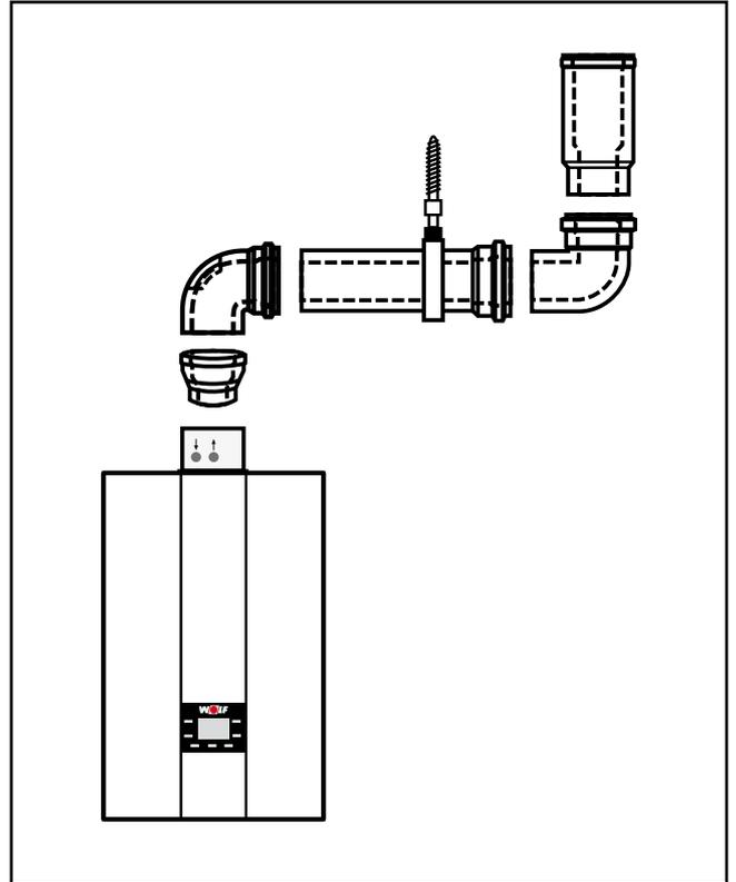
Figura: Esempio di sistema di aspirazione aria/scarico fumi
