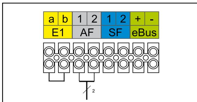
Figura: Collegamento del sensore esterno
