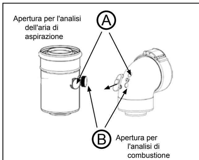
Figura: Analisi dell'aria di aspirazione e dei parametri fumi del sistema di scarico fumi 60/100 per le esecuzioni opzionali
