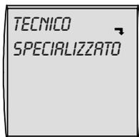
Premere la manopola destra per passare nel 2° livello di comando. Ruotando la manopola destra in senso orario, selezionare il menu "tecnico specializzato" e confermare la selezione premendo nuovamente la manopola destra. Sul display compare la richiesta del codice.
