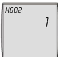
All'interno dell'intervallo di modulazione è possibile adattare la potenza inferiore del bruciatore in modalità riscaldamento. L'impostazione si riferisce alla potenza termica massima in KW (vedere tabella "Limitazione della potenza termica massima").
