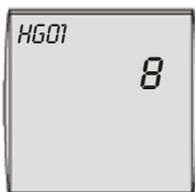
Il differenziale di commutazione del bruciatore regola la temperatura della caldaia entro il range impostato accendendo e spegnendo il bruciatore. Più il differenziale impostato per la temperatura di spegnimento è alto, maggiore è l'oscillazione della temperatura di caldaia al di sopra del valore nominale.
