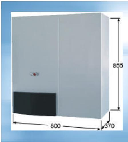
Gruppo termico pensile a condensazione, preassemblato, composto da caldaia murale a condensazione con scambiatore secondario a piastre in acciaio inox ed accumulo a stratificazione in acciaio inox.
