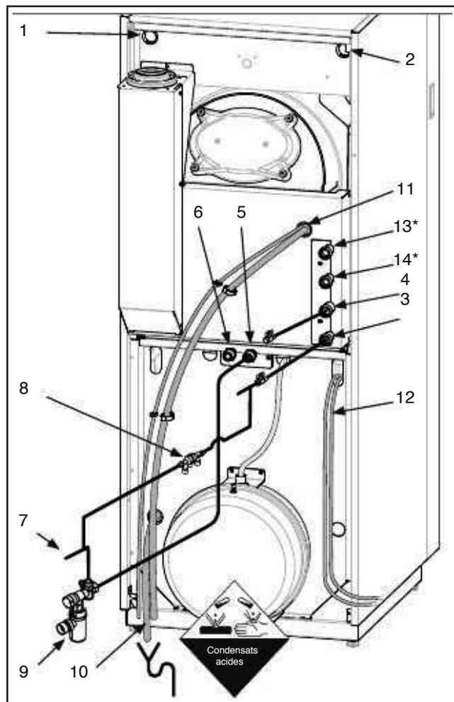
Collegare l'uscita della valvola di sicurezza con un sifone. Installare una sicurezza contro la mancanza di acqua quando la caldaia è installata nel punto alto dell'impianto. (Per esempio nel sottotetto)
