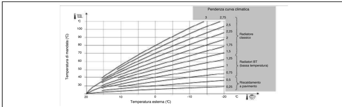
Il funzionamento della caldaia è subordinato alla curva climatica. La temperatura dell'acqua del circuito di riscaldamento viene regolata in funzione della temperatura esterna.
