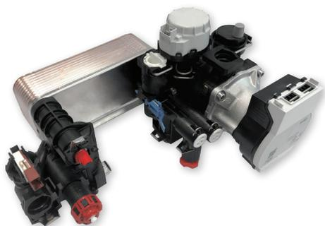
Il notevole aumento della sezione di passaggio dello **scambiatore a 20 piastre** rispetto ad uno tradizionale (es. a 14 piastre) ne **riduce fortemente l'intasamento nel tempo, anche in presenza di acque particolarmente dure**, aumentando di molto la vita media dello stesso e riducendo al minimo i costi di manutenzione.
