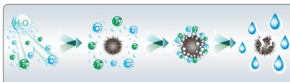
**Ionizzatore d'Aria (Cold Plasma Generator):** è in grado di abbattere gli inquinanti decomponendone le molecole tramite scariche elettriche, provocando la scissione delle molecole d'acqua presenti nell'aria in ioni positivi e negativi. Tali ioni neutralizzano le molecole degli inquinanti gassosi ottenendo prodotti normalmente presenti nell'aria pulita. Il dispositivo è in grado di eliminare il 90% dei batteri. Il risultato è un'aria pulita, ionizzata e priva di cattivi odori.
