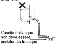
Inclinare leggermente il tubo di scarico verso il basso. Il tubo di scarico non deve essere curvato, sollevato, ondeggiante, ecc.
