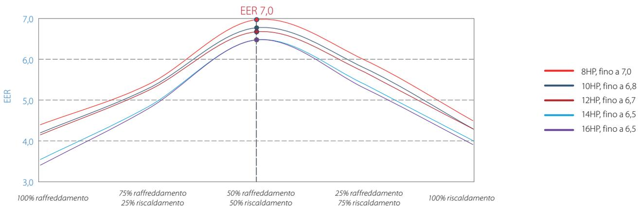
EER in modalità di raffreddamento e riscaldamento simultanei si basano sulle seguenti condizioni:
