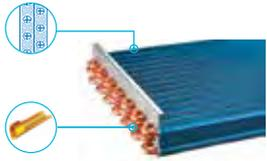
La finestratura delle alette permette di incrementare l'area di scambio, diminuendo la resistenza dell'aria, risparmiando più energia e migliorando le prestazioni dello scambio termico. Il rivestimento idrofilico delle alette e la filettatura interna dei tubi di rame ottimizzano l'efficienza dello scambio termico. La valvola di espansione elettronica garantisce una regolazione precisa del refrigerante nello scambiatore.
