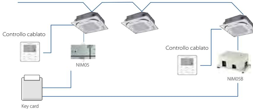
\* Comandi a filo compatibili con NIM05/NIM05B solo se collegati tramite display board
