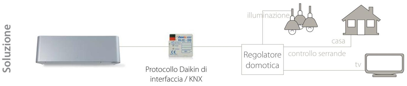
**Collegamento di unità interne Sky Air / VRV all'interfaccia KNX per l'integrazione con i sistemi di gestione centralizzata degli edifici (BMS)**
