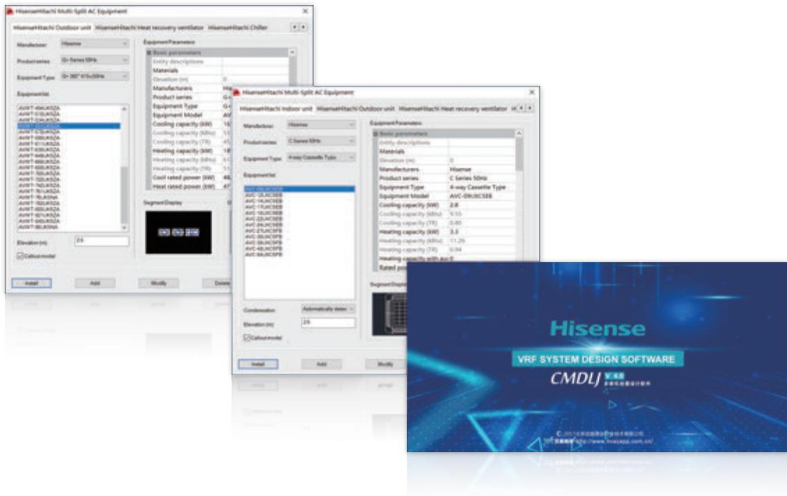
Il design software Hisense si interfaccia con il programma Autocad 2008-2016 e supporta l'utente nella definizione dello schema delle tubazioni, della carica di refrigerante e del materiale installativo.
