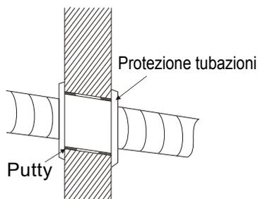
**Note:** Normalmente il foro sul muro è di  $\varnothing 60\text{mm}$ – $\varnothing 80\text{mm}$ .
