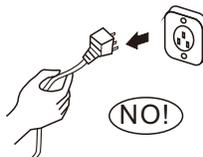
Il danneggiamento del cavo di alimentazione può provocare scosse elettriche.
