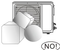
La capacità di riscaldamento/raffrescamento saranno ridotte e l'unità si potrebbe bloccare.
