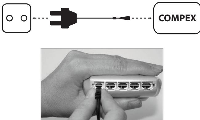
Rimuovere tutti i cavi di elettrostimolazione dall'unità prima di avviare la ricarica. Introdurre il caricatore in una presa elettrica e collegare lo stimolatore facendo scorrere la levetta rossa verso destra per mostrare il connettore del caricatore. È vivamente consigliato caricare completamente la batteria prima del primo utilizzo al fine di migliorarne le prestazioni e la durata.
