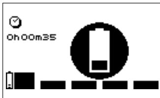
De duur van het opladen wordt op het scherm weergegeven. Zodra het laden gereed is, begint het batterijpictogram te knipperen. Ontkoppel de lader. De stimulator wordt dan automatisch uitgeschakeld.
