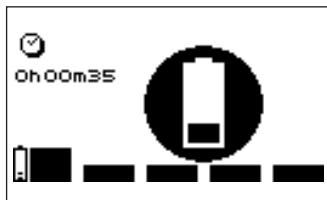
Die Aufladedauer wird auf dem Bildschirm angezeigt. Sobald das Aufladen beendet ist, blinkt das Akkusymbol. Das Ladegerät abnehmen; der Stimulator schaltet sich automatisch aus.
