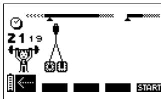
O dispositivo emite um sinal sonoro e apresenta alternadamente o símbolo de par de eléctrodos e uma seta a apontar para o canal onde foi detectado um problema. No exemplo acima, o estimulador detectou um erro no canal 1.
