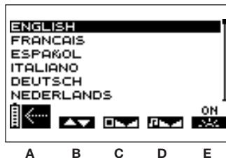
**B** Tryck på +/- för kanal 1 för att välja det språk som ska användas.
