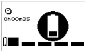
En la pantalla se muestra duración de la carga. Una vez que finaliza la carga, la batería parpadea. Desconecte el cargador: el estimulador se apagará automáticamente.
