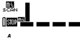
**A** Zum Beenden des Tests die Ein/Aus-Taste drücken.
