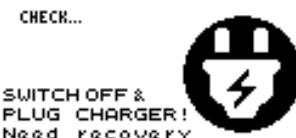
Als het ladingsniveau van de batterij erg laag is, begint een herstelcyclus die twee minuten duurt.
