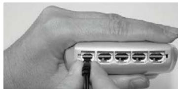
Rimuovere tutti i cavi di elettrostimolazione dall'unità prima di avviare la ricarica. Introdurre il caricatore in una presa elettrica e collegare lo stimolatore facendo scorrere la levetta rossa verso destra per mostrare il connettore del caricatore. È vivamente consigliato caricare completamente la batteria prima del primo utilizzo al fine di migliorarne le prestazioni e la durata.
