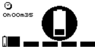
En la pantalla se muestra duración de la carga. Una vez que finaliza la carga, la batería parpadea. Desconecte el cargador: el estimulador se apagará automáticamente.
