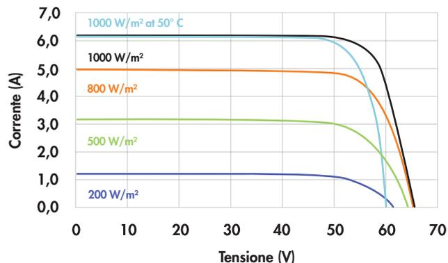
Caratteristiche di corrente/tensione a seconda dell'irraggiamento e della temperatura del modulo.
