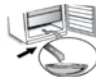
Una volta terminata l'operazione, riportare lo scarico dell'acqua di sbrinamento nella posizione originale.
