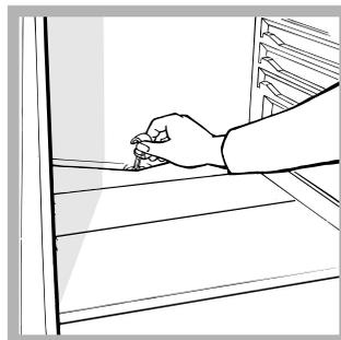
*Abbildung*) abgeleitet, wo es dank der vom Kompressor erzeugten Wärme verdampft. Diese kleine Öffnung sollte jedoch regelmäßig gereinigt werden, damit das Tauwasser unbehindert ablaufen kann.
