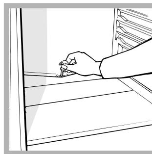
Il frigorifero è dotato di sbrinamento automatico: l'acqua viene convogliata verso la parte posteriore da un apposito foro di scarico (*vedi figura*) dove il calore prodotto dal compressore la fa evaporare. L'unico intervento da fare periodicamente consiste
