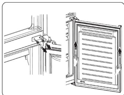
6. Rimuovere il fermaporta, allentando la vite "3" (ricordarsi la posizione del supporto). Rimuovere i tasselli di copertura dalla parte opposta. Ruotare il fermoporta di 180° ed assemblarlo dal lato opposto con la vite rimossa in precedenza. Assemblare i tasselli di copertura dal lato opposto. Ripetere l'operazione con la porta inferiore.
