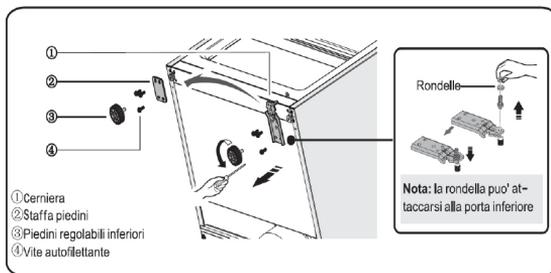
8. Invertire la posizione della cerniera con quella della staffa piedini e riavvitare le sei viti di fissaggio serrando con forza. Riavvitare i piedini.
