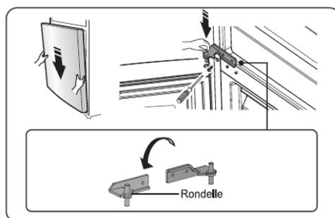
11. Ruotare la cerniera superiore ed invertire la posizione del cardine.
