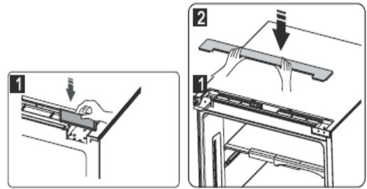
12. Reinserire la porta superiore centrando il cardine della cerniera centrale con la porta. Inserire la cerniera superiore centrando il cardine della cerniera con il foro superiore della porta. Posizionare la cerniera superiore sulla traversa del mobile e fissarla con le viti serrando con forza. **Attenzione!** Tenere saldamente la porta durante l'operazione.
