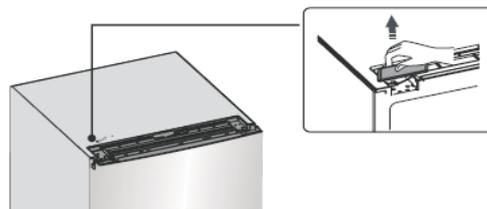
3. Rimuovere la cerniera sul lato superiore destro svitando le tre viti di blocco. **Attenzione!** tenere la porta saldamente per evitare la caduta.
