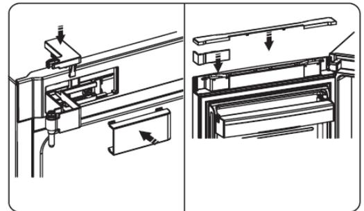
14. Come ultima operazione invertire le maniglie dal lato sinistro al lato destro della porta, per il dettaglio dell'operazione fare riferimento alla sezione "Installazione maniglia".
