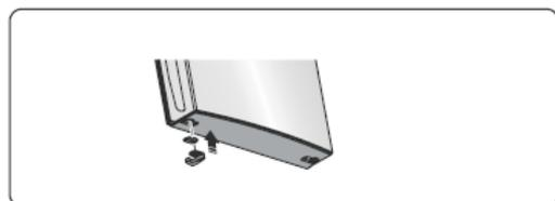
7. Inclinare il frigo per avere accesso ai piedini. Rimuovere i 2 piedini anteriori regolabili svitandoli verso sinistra. Rimuovere le 3 viti che fissano la cerniera, rimuovere le 3 viti che fissano la staffa piedini sul lato opposto.
