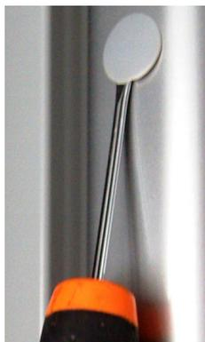
Posizionare la manopola sul mobile ed inserire la vite nel foro superiore, serrando con forza. Ripetere l'operazione per il foro inferiore.
