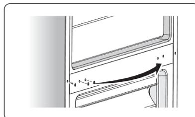
10. Reinscrivere la porta inferiore centrando il cardine della cerniera inferiore con la porta. Inserire la cerniera centrale centrando il cardine della cerniera con il foro superiore della porta. Posizionare la cerniera centrale sulla traversa del mobile e fissarla con le viti serrando con forza.
