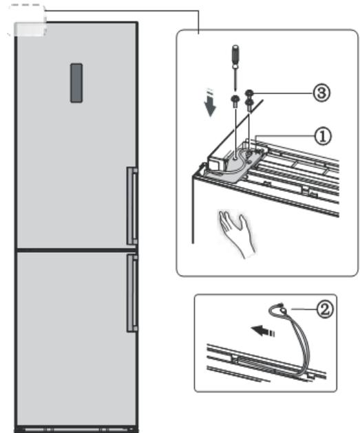
13. Invertire il senso del filo che collega il display alla porta (solo nel modello con display). Inserire le coperture sui fori lasciati scoperti.
