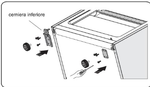
11. Reinscrivere la porta inferiore centrando il cardine della cerniera inferiore con la porta. Inserire la cerniera centrale centrando il cardine della cerniera con il foro superiore della porta. Posizionare la cerniera centrale sulla traversa del mobile e fissarla con le viti serrando con forza.
