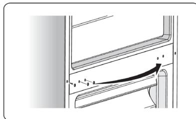
9. Inclinare il frigo per avere accesso ai piedini. Rimuovere i 2 piedini anteriori regolabili svitandoli verso sinistra. Rimuovere le 3 viti che fissano la cerniera, rimuovere le 3 viti che fissano la staffa piedini sul lato opposto.
