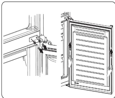
7. Rimuovere il fermaporta, allentando le viti "4" e "3" (ricordarsi la posizione delle rondelle). Rimuovere i tasselli di copertura dalla parte opposta. Ruotare il fermoporta di 180° ed assemblarlo dal lato opposto con le viti rimosse in precedenza. Assemblare i tasselli di copertura dal lato opposto. Ripetere questa operazione anche per la porta superiore.
