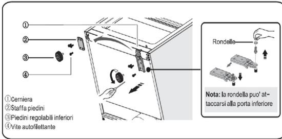
10. Invertire la posizione della cerniera con quella della staffa piedini e riavvitare le sei viti di fissaggio serrando con forza. Riavvitare i piedini.
