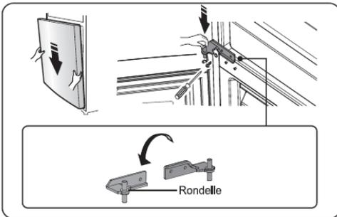
12. Reinscrivere la porta superiore centrando il cardine della cerniera centrale con la porta. Inserire la cerniera superiore centrando il cardine della cerniera con il foro superiore della porta. Posizionare la cerniera superiore sulla traversa del mobile e fissarla con le viti serrando con forza. **Attenzione!** Tenere saldamente la porta durante l'operazione.
