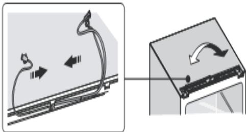
ruotare di 180° e riassemblare le viti (solo per il modello display). Riassemblare la cerniera sul lato sinistro con le due viti rimosse in precedenza, inserire il cavo di terra sotto la vite interna e serrare con forza. Assemblare il coperchio di copertura sul lato opposto della cerniera.
