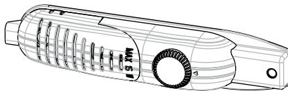
Le thermostat règle automatiquement la température intérieure du compartiment du réfrigérateur et du compartiment du congélateur. En tournant le bouton de la position 1 à 5, vous pouvez obtenir des températures plus froides.
