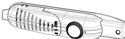
• El termostato regula automaticamente la temperatura interior del compartimento del frigorífico. Girando el mando del selector desde la posición 1 a la 5, puede obtener temperaturas más frias.
