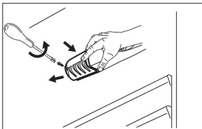
3. Sostituire la lampadina con una della stessa potenza e con caratteristiche identiche, specificamente studiata per gli elettrodomestici.
