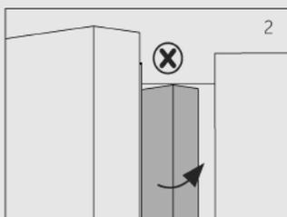
Existe uma linha de aquecimento no interior da barra da porta vertical. A temperatura da superfície aumentará ligeiramente, o que é norma e que não afetará o funcionamento do frigorífico.
