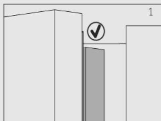
Ha megpróbálja bezárni a bal ajtót és a függőleges ajtószél nincs behajtvva (2), akkor először hajtsa be, máskülönben az ajtó nekiütődik a megerősítő pántnak vagy a jobb ajtónak. Így az ajtószél megsérülhet, vagy szivárgás léphet fel.
