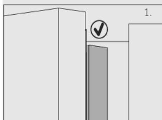
Schließen Sie die linke Tür nur mit eingeklappter Türleiste (1).
