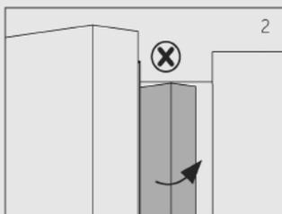
W pionowym ryglu drzwiowym znajduje się zwój grzewczy. Temperatura powierzchni nieco wzrośnie, co jest normalne i nie ma wpływu na funkcjonowanie lodówki.
