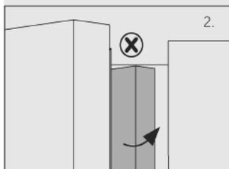
Anderenfalls (2) kann die Türleiste verbiegen und deren Aufhängung oder die rechte Tür beschädigt werden, sodass die Dichtung und Kühlleistung nicht mehr gewährleistet ist.
