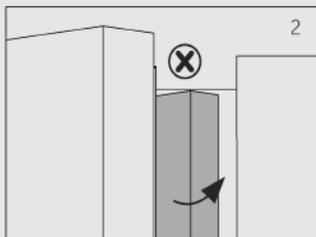
A függőleges ajtószélben van egy fűtőszál. A felület hőmérséklete kissé növekedhet, de ez normális jelenség és nem befolyásolja a hűtőszekrény működését.
