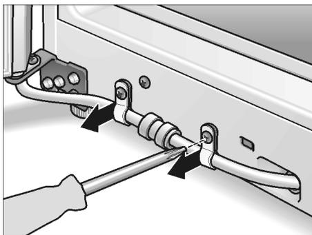
Spennringen trykkes i pilens retning, samtidig trekkes slangen ut av slangeforbindelsen.
