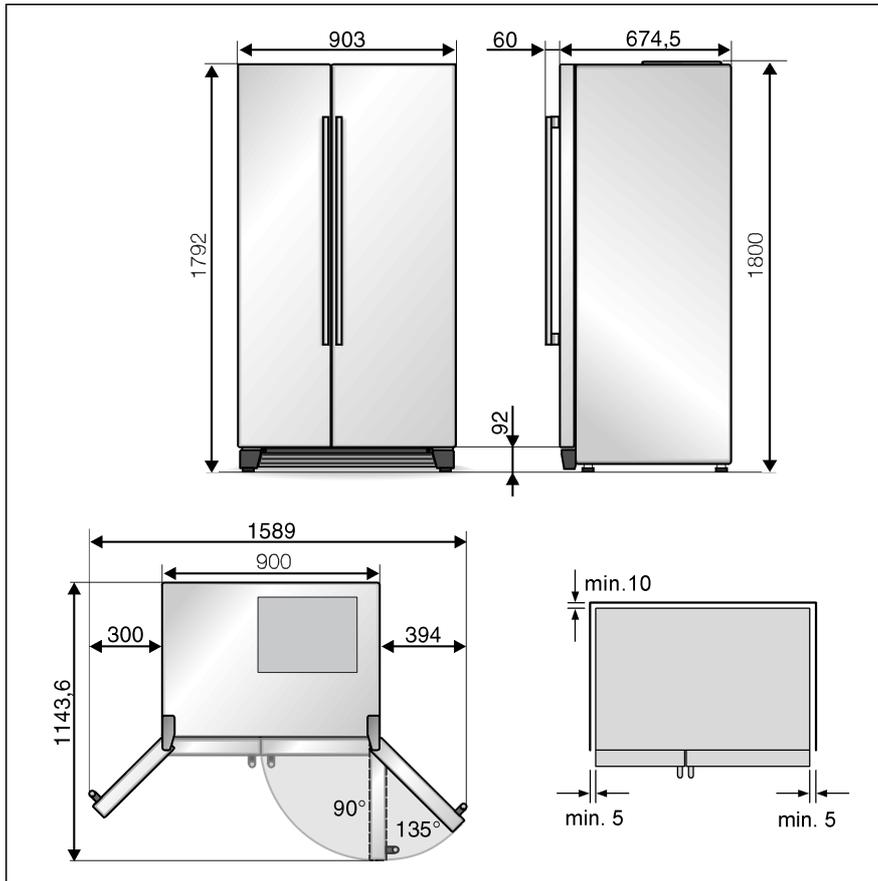
Cihazın kurulacağı yerin etrafındaki mutfak donanımının derinliği 60 cm'yi aşıyorsa, kapıların açılma açısından tamamen yararlanabilmek için, yan taraflarda asgari mesafeler olmasına dikkat edilmelidir.
