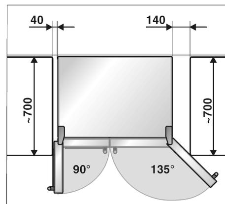
Si vous montez un cache ou un placard au-dessus de l'appareil, il faudra prévoir un espace libre pour pouvoir si nécessaire sortir l'appareil de la cavité.
