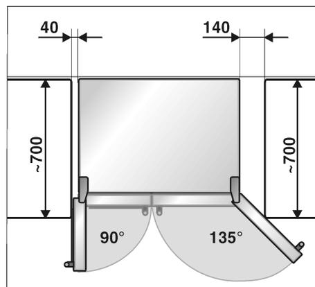
Se sopra l'apparecchio si monta un pannello oppure un pensile, è necessario prevedere una fessura per estrarre l'apparecchio dalla nicchia in caso di necessità.
