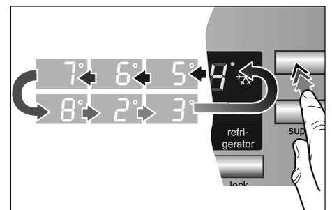
Der zuletzt angezeigte Wert wird vom System gespeichert.
