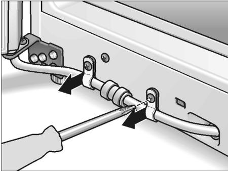
Spanning in de richting van de pijl drukken en tegelijkertijd de slang uit de slangverbinding trekken.
