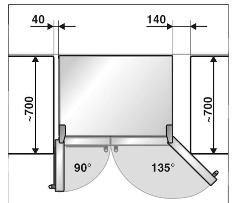
Dersom apparatet skal bygges inn oppe med et panel eller et annet skap, må det lages en spalte, slik at apparatet om nødvendig kan trekkes ut av nisjen.
