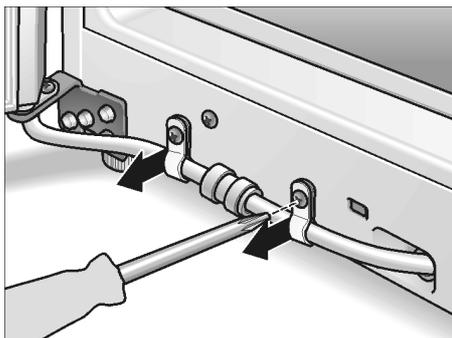
Spannung in Pfeilrichtung drücken, gleichzeitig Schlauch aus der Schlauchverbindung ziehen.
