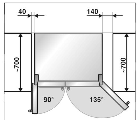
Wird das Gerät oben mit einer Blende oder einem Schrank überbaut, ist ein Spalt vorzusehen, damit das Gerät bei Bedarf aus der Nische herausgezogen werden kann.
