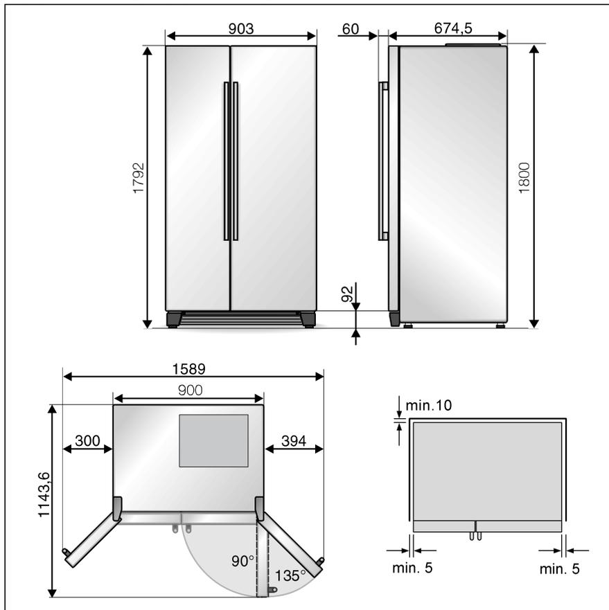
Dersom dybden på den øvrige innretningen på kjøkkenet overstiger 60 cm, må det overholdes en minsteavstand for å kunne utnytte den fulle åpningsvinkelen på døren.
