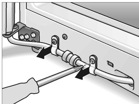
Πιέστε τον δακτύλιο σύσφιξης στην κατεύθυνση του βέλους, τραβήξτε ταυτόχρονα τον εύκαμπτο σωλήνα από τη σύνδεση εύκαμπτων σωλήνων.
