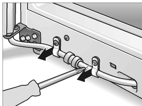
Presionar el anillo tensor en dirección a la flecha y desempalmar simultáneamente la manguera de su acoplamiento.
