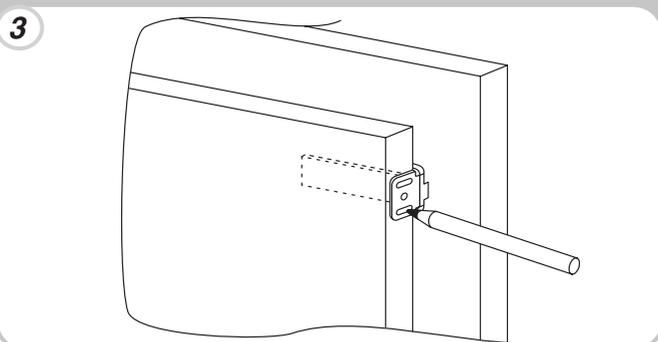
Připevněte dvířka spotřebiče k panelu skříňky přišroubováním do vyvrтанých otvorů.
