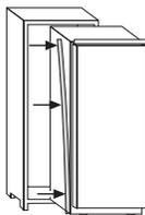
Nainstalujte spotřebič do skříňky a vyrovnejte ho na opačné straně od závěsů.
