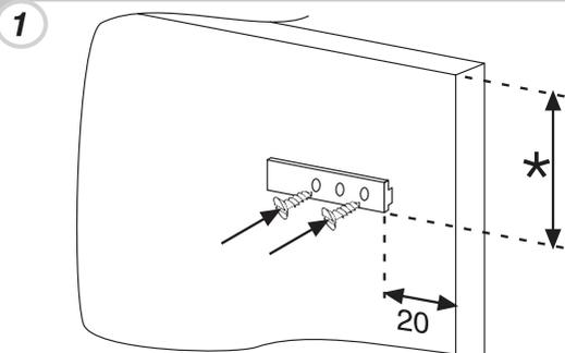
Ouvrez les portes du meuble et du réfrigérateur. Placez le dispositif d'entraînement dans la glissière puis ajustez-le sur la porte du réfrigérateur.
