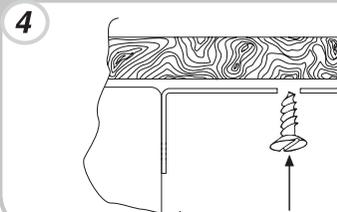
Kiinnitä laitteen alaosaa mukana toimitetuilla ruuveilla.
