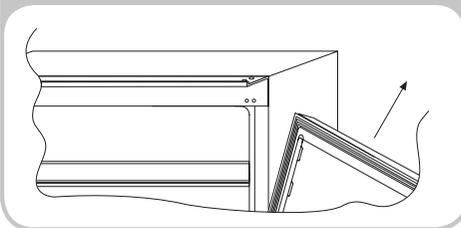
Saque la clavija de la bisagra de la zona inferior derecha y vuelva a colocarla en la bisagra de la zona inferior izquierda.
