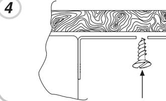
Bevestig de onderkant van het apparaat met de meegeleverde schroeven.
