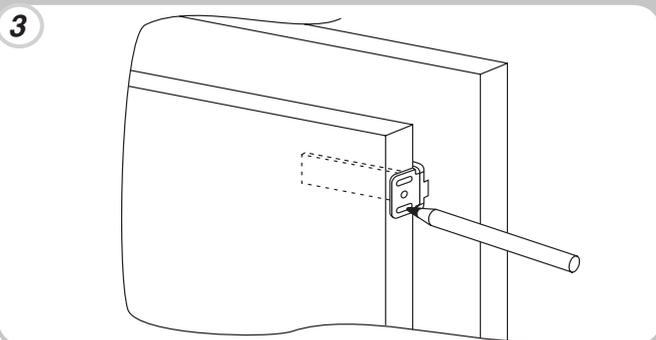
Conecte la puerta del aparato al panel de la cabina, guardando los soportes de guía como referencias.
