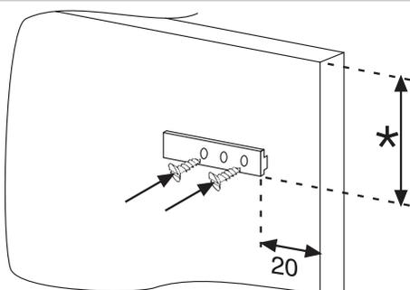
Open de deuren van de inbouwkast en die van de koelkast. Plaats de geleider op de inbouwkastdeur in de glijschuif, en positioneer deze glijschuif vervolgens op de deur van de koelkast.
