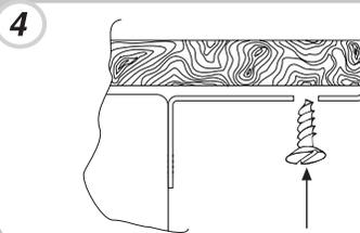
Befestigen Sie den unteren Teil des Geräts mit den beigelegten Schrauben.
