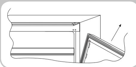
Vyjměte čep ze spodní části pravého závěsu a namontujte ho na spodní levý závěs.
