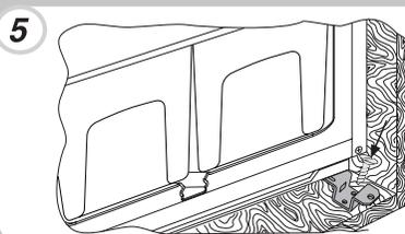
Bringen Sie das Belüftungsgitter an.
