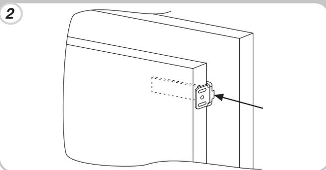
Marker festepunktene til skruene og lag hull med et bor med diameter på 2.5.
