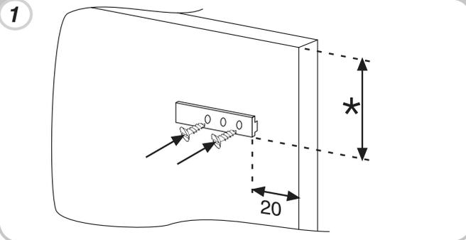
Öffnen Sie die Türen des eingebauten Standschranks und den Kühlschrank. Positionieren Sie den eingebauten Lader im Schieber, und setzen Sie ihn anschließend in die Kühlschranktür ein.
