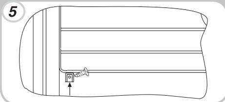
Lösen Sie die Schrauben des Hakens auf der linken Seite des Gefrierfachs.
