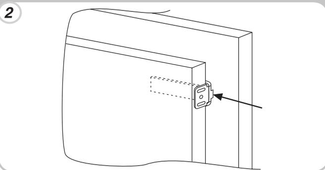
Markera fästpunkterna för skruvarna och borra med ett bits på en diameter av 2,5.
