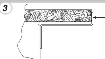
Bloccare la parte superiore dell'apparecchio al mobile, utilizzando le viti in dotazione.
