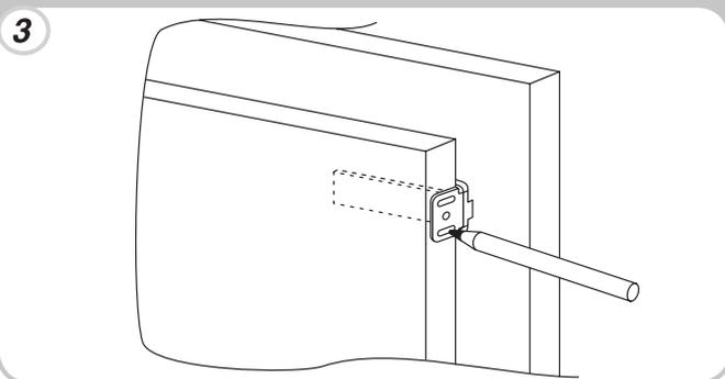
Liitä laitteen ovi kaapiston paneeliin käyttämällä kiskon reikiä apuna.
