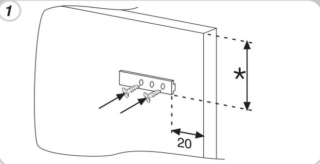
Ανοίξτε τις πόρτες του κάθετου ντουλαπιού εντοιχισμού και του ψυγείου. Τοποθετήστε το στήριγμα εντοιχισμού στον οδηγό ολίσθησης και κατόπιν προσαρμόστε το στην πόρτα του ψυγείου.
