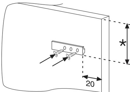
Åbn det indbyggede skabs døre og køleskabsdøre. Placer den indbyggede læsseanordning i slæden, og tilpas den så i køleskabsdøren.
