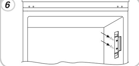
Saque todas las clavijas de la cubierta, tal y como se indica en la ilustración.
