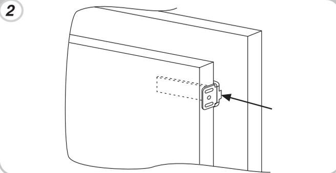
Markieren Sie die Befestigungspunkte für die Schrauben und bohren Sie ein Loch mit einem Durchmesser von 2,5.
