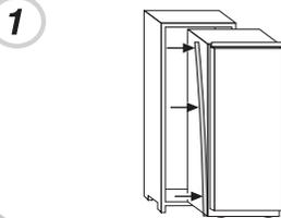
Plaats het apparaat in de inbouwkast, en lijn het apparaat uit aan de tegenovergestelde kant van de scharnieren.
