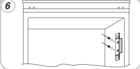
Entfernen Sie die Stopfen von der Lochabdeckung, wie im Bild dargestellt.
