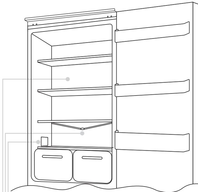
Forma-se uma pequena quantidade de gelo ou de gotas de água na parede do frigorífico.
