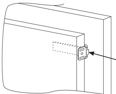
Marker indspændingsstederne for skruerne og bor med et bor med en diameter på 2.5.
