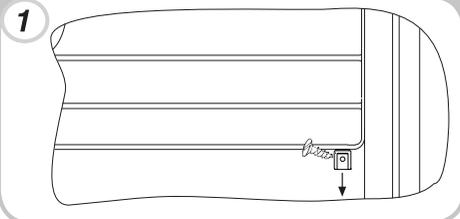
Positionieren Sie die Tür und das Scharnier zuerst und schrauben Sie dann das Scharnier an das Produkt.
