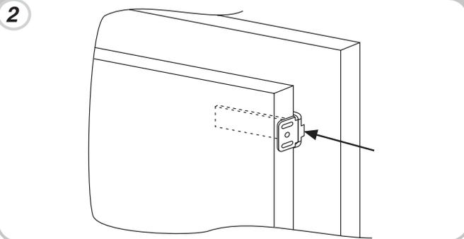
Marque los puntos de fijación para los tornillos y agúrelos con un diámetro de 2,5.
