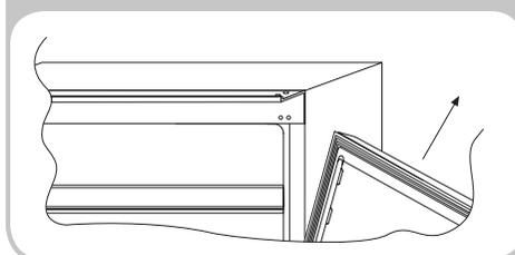
Avlägsna stiftet i det nedre högra gångjärnet och sätt det i det nedre vänstra gångjärnet.
