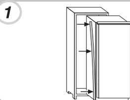
Fixez le haut de l'appareil à l'armoire en utilisant les vis fournies.
