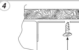
Bloccare la parte inferiore dell'apparecchio mediante le viti in dotazione.
