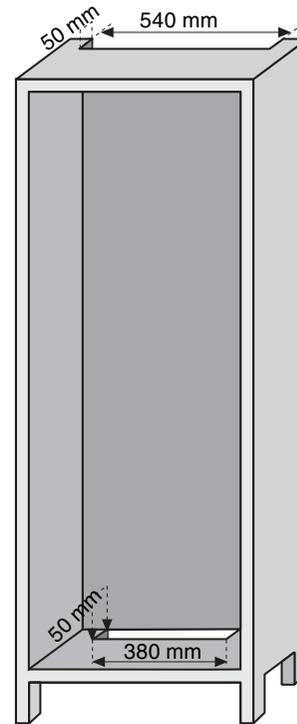
Abmessung zwischen dem Spalt, der zwischen Standschrank und Decke bleiben muss.
