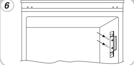
Wymij czopy zakrywające otwory, tak jak pokazano na rysunku.
