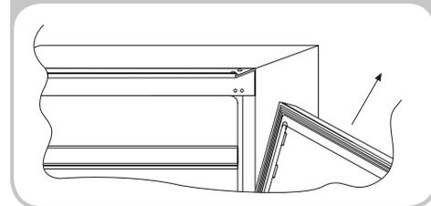
Rimuovere il perno della cerniera inferiore destra e rimontarlo sulla cerniera inferiore sinistra.
