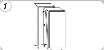
Τοποθετήστε τη συσκευή στο κάθετο ντουλάπι, τοποθετώντας την στην αντίθετη πλευρά των μεντεσέδων.
