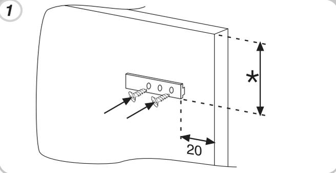
Abra las puertas de la columna integrada y del frigorífico. Ubique el cargador integrado en la placa, y a continuación, ajústelo a la puerta del refrigerador.
