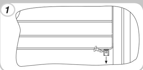
Τοποθετήστε την πόρτα και το μεντεσέ πρώτα και κατόπιν βιδώστε το μεντεσέ στη συσκευή.
