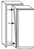
Installer apparatet i skabet, idet du placerer det på den modsatte side af hængslerne.
