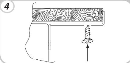
Στερεώστε το κάτω τμήμα της συσκευής με τις παρεχόμενες βίδες.
