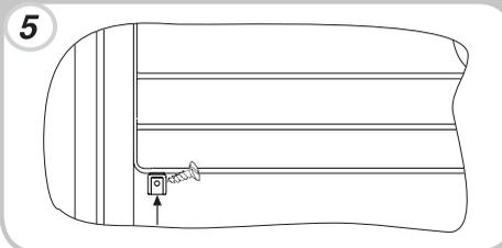
Schroef de haak aan de linkerzijde van het diepvriescompartiment los.
