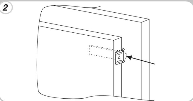
Označte si body připevnění a vyvrtejte si otvory o průměru 2,5.
