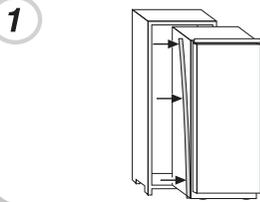
Insira o aparelho na coluna, colocando-o no lado oposto ao dos fechos.
