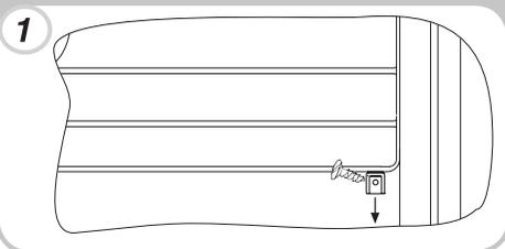
Positioneer eerst de deur en het scharnier en schroef dan het scharnier op het apparaat vast.
