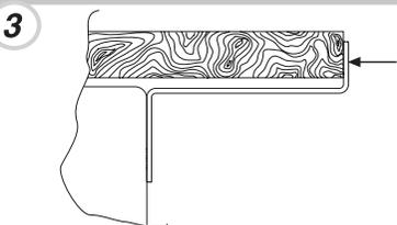
Kiinnitä laitteen yläosa kaappiin mukana toimitettujen ruuvien avulla.
