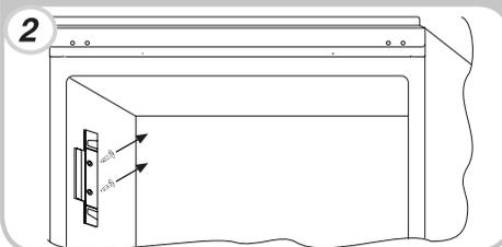
Schroef de haak aan de rechterzijde van het diepvriescompartiment vast.
