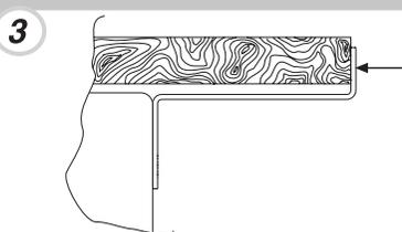
Zamocuj górną część urządzenia do obudowy za pomocą dostarczonych w zestawie wkrętów.
