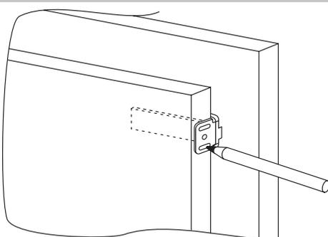
Verbind de deur van het apparaat met de inbouwkastdeur middels de geleiders en glijschuiven.
