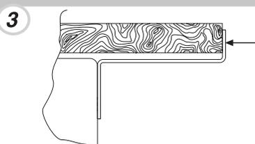
Fäst enhetens övre del vid skåpet med de medföljande skruvarna.
