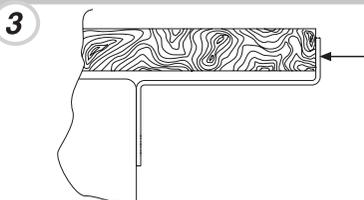
Befestigen Sie den oberen Teil des Geräts mit den beigelegten Schrauben.
