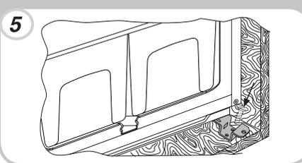
Τοποθετήστε τη σχάρα αερισμού.
