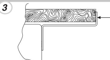
Bevestig het bovenste gedeelte van het apparaat aan de inbouwkast, middels de meegeleverde schroeven.
