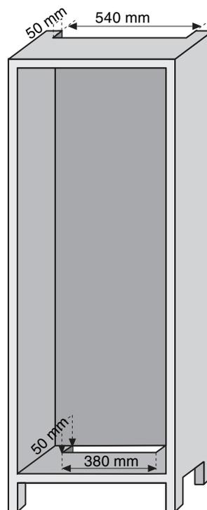
Dimensões da falha entre a coluna e o tecto.
