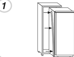
Setzen Sie das Gerät in den Standschrank ein, platzieren Sie es auf der gegenüberliegenden Seite der Scharniere.
