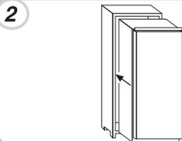
Vergewis u ervan dat de bovenkant van het apparaat perfect op de inbouwkast aansluit.
