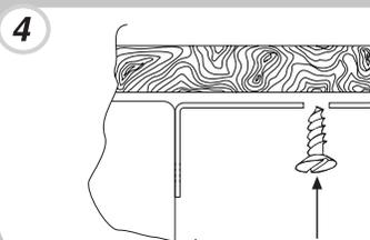
Przymocuj dolną część urządzenia wkrętami dostarczonymi w zestawie.
