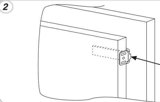
Marquez les points de fixation pour les vis et percez à l'aide d'un foret de diamètre 2.5.
