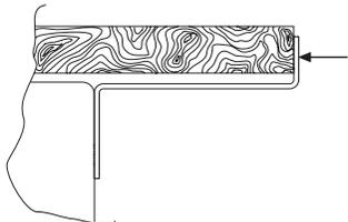
Horní část spotřebiče připevněte ke skříňce pomocí dodaných šroubů.
