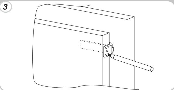
Zamocować drzwi urządzenia do panelu zabudowy, odpowiednio do pozycji szyn i prowadnic.
