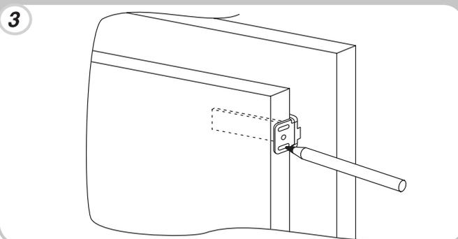
Montieren Sie die Gerätetür an der Schrank-Stirnwand, nutzen Sie die Schlitzle der Schlitten als Referenz.
