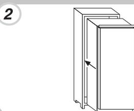
Upewnij się, że górna płyta dokładnie pasuje do obudowy.
