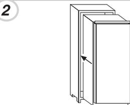
Forsikre deg om at topplaten passer perfekt inn i skapet.
