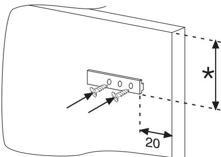
Abra as portas da coluna integrada e do frigorífico. Posicione o carregador interno na guia e depois instale-o na porta do frigorífico.
