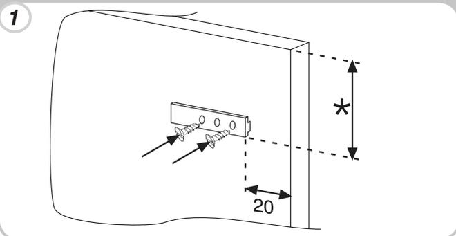
Otworzyć drzwi zabudowy i drzwi chłodziarki. Umieścić wbudowaną prowadnicę w szynie i zamocować całość do drzwi chłodziarki.
