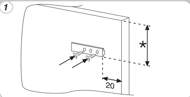
Åpne dørene til det innebygde skapet og kjøleskapet. Plasser hengeålet til skapet i skyvefestet og fest det til kjøleskapsdøren.
