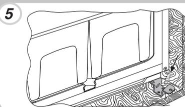
Assurez-vous que la plaque supérieure de l'armoire s'ajuste parfaitement à l'armoire.
