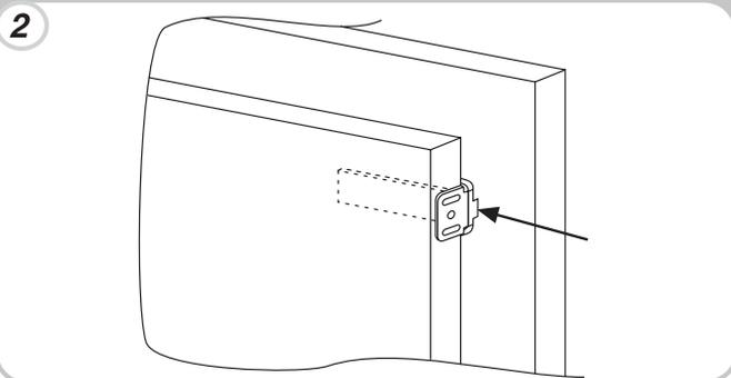
Contrassegnare i punti di fissaggio per le viti e forare con una punta di diametro 2,5.
