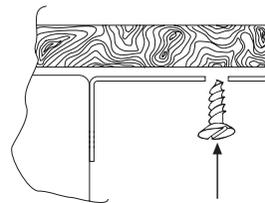
Upevněte spodní část spotřebiče pomocí dodaných šroubů.
