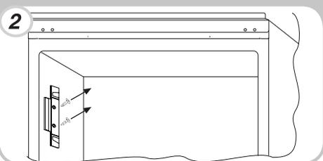
Skru fast kroken på høyre side av fryserseksjonen.
