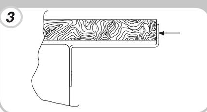
Στερεώστε το πάνω τμήμα της συσκευής στο ντουλάπι χρησιμοποιώντας τις παρεχόμενες βίδες.
