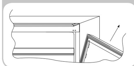
Fjern pluggen på nederste hengsel på høyre side og sett den i hengselen nederst på venstre side.
