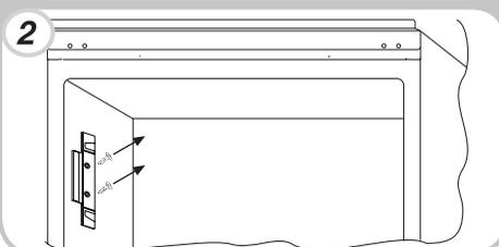
Skruva fast kroken på frysens högra sida.
