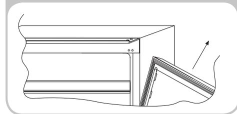
Entfernen Sie den Stift des Scharniers unten rechts und befestigen Sie es erneut am Scharnier unten links.
