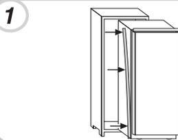
Sett apparatet inn i skapet på motsatt side av hvor hengslene sitter.
