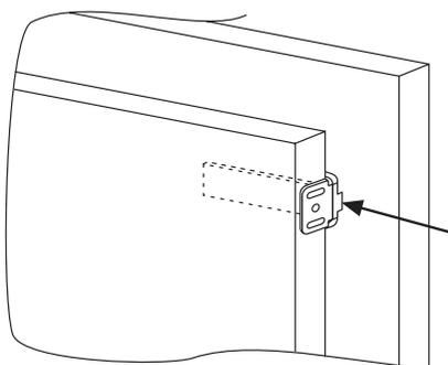
Marque os pontos de fixação dos parafusos e perfure um diâmetro de cerca de 2,5.
