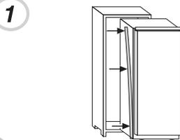
Introduzca el aparato en la columna, colocándolo en la parte opuesta de las bisagras.
