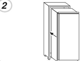
Stellen Sie sicher, dass die obere Platte des Schrankes perfekt in den Schrank passt.
