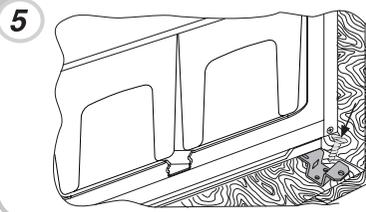
Coloque a grelha de ventilação.
