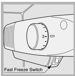
Active la congelación rápida cuando se introducen alimentos frescos para congelar. Para activar la congelación rápida, lleve el interruptor hasta la posición "I": El interruptor pone en marcha un enfriamiento intenso que garantiza que se alcancen las temperaturas necesarias
