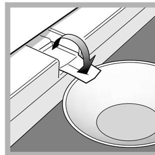
**SISTEMA DRAIN** care dirijează apa spre exterior. Azați un recipient (vezi figura) pentru a recolta apa eliminată.
