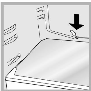
(ver la figura) donde el calor producido por el compresor la hace evaporar. La única intervención que se debe realizar periódicamente consiste en limpiar el orificio de descarga para que el agua pueda fluir libremente.
