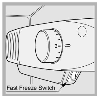
Szybkie zamrażanie należy włączyć podczas wkładania do lodówki świeżej żywności przeznaczonej do zamrożenia. Aby włączyć szybkie zamrażanie, należy przestawić przełącznik na pozycję „1”: przełącznik uruchamia intensywne chłodzenie,
