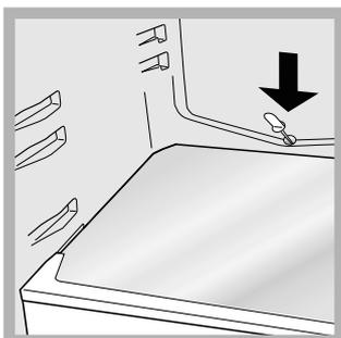
orificiu de evacuare (vezi figura) de unde, cu ajutorul căldurii emanate, se evaporă. Singura intervenție pe care trebuie să o efectuați periodic constă în curățarea orificiului de evacuare pentru ca apa să poată circula fără obstacole.
