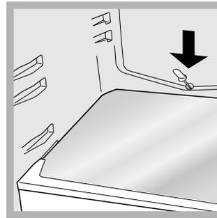
Il frigorifero è dotato di sbrinamento automatico: l'acqua viene convogliata verso la parte posteriore da un apposito foro di scarico (vedi figura) dove il calore prodotto dal compressore la fa evaporare. L'unico intervento da fare periodicamente consiste nel pulire il foro di scarico
