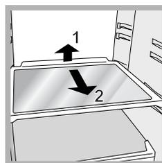
Sono estraibili e regolabili in altezza grazie alle apposite guide (vedi figura), per l'inserimento di contenitori o alimenti di notevole dimensione. Per regolare l'altezza non è necessario estrarre completamente il ripiano.
