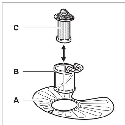
1. Ruotare il filtro (B) in senso antiorario e rimuoverlo.
