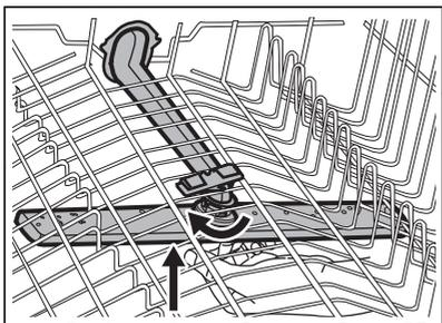
3. Lave o braço aspersor em água corrente. Utilize um objecto fino e pontiagudo, por exemplo um palito, para remover a sujidade dos orifícios.
