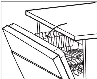
**i** Mentre la fase di asciugatura è in funzione, un dispositivo apre la porta dell'apparecchiatura. La porta viene tenuta socchiusa.
