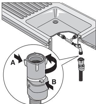
Il tubo di carico è costituito da una doppia guaina protettiva contro eventuali danneggiamenti, la più esterna trasparente. Se il tubo di carico dell'acqua è danneggiato, l'acqua che si trova nel tubo diventa scura. La si può vedere attraverso la guaina esterna trasparente. Chiudere il rubinetto dell'acqua e contattare il centro assistenza per sostituire il tubo di carico dell'acqua con la valvola di sicurezza.
