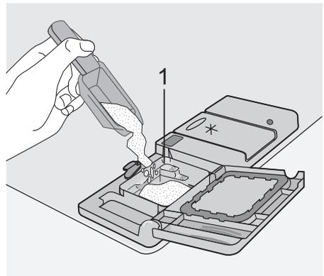
3. Tutti i programmi con prelavaggio richiedono una piccola quantità di detersivo (5/10 g) da versare nel contenitore detersivo WRD, posizionato al centro del cesto superiore.
