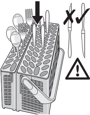
Se i manici sporgono dal fondo del cestello, bloccando la rotazione del mulinello inferiore, capovolgere le posate. Mischiare i cucchiai ad altre posate per impedire che aderiscano l'uno all'altro. Abbassare il manico del cestello per facilitare la sistemazione delle posate.
