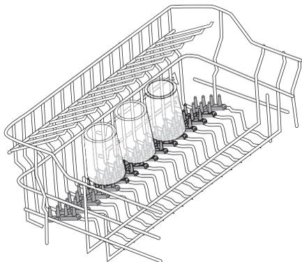
Vedere le figure per il corretto posizionamento dei supporti in gomma per bicchieri. Per la massima flessibilità possono essere posizionati sul lato destro o sinistro del cesto. Dopo averli correttamente posizionati, premerli a fondo accertandosi che non possano muoversi.
