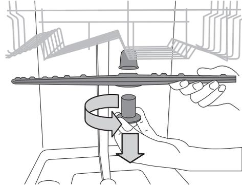
Per rimuovere l'irroratore superiore, ruotare la ghiera di bloccaggio in plastica nel verso antiorario. Il braccio irroratore superiore dev'essere posizionato in modo che il lato con più fori sia rivolto verso l'alto.
