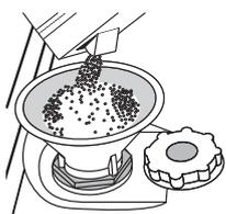
1. Rimuovere il cestello inferiore e svitare il tappo del serbatoio (in senso antiorario).
