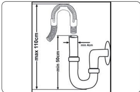
Collegare il tubo di scarico dell'acqua direttamente al foro di scarico dell'acqua o al raccordo di uscita del lavandino. Questo collegamento deve essere sopra al livello del pavimento da un minimo 50 cm a un massimo 110 cm di altezza.
