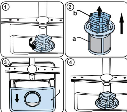
Per rimuovere e pulire la combinazione del filtro, ruotarlo in senso antiorario e rimuoverlo sollevandolo verso l'alto (1). Estrarre il filtro grosso dal micro filtro (2). Quindi estrarre e rimuovere il filtro in metallo (3). Sciocquare il filtro con molta acqua fino a che non è privo di residui. Riasssemblare i filtri. Sostituire l'inserito del filtro e ruotarlo in senso orario (4).
