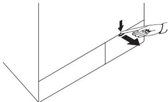
Se il coperchio del filtro si compone di un unico elemento, tirare il coperchio da entrambi i lati sulla parte alta per aprire.
