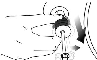
3. Inserire i coperchietti in plastica nei fori del pannello posteriore, in dotazione nel sacchetto allegato al manuale utente. (P)
