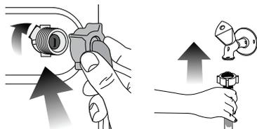
3. Aprire completamente i rubinetti dopo aver collegato il flessibile per controllare se ci sono perdite di acqua nei punti di connessione. In caso di perdite, chiudere il rubinetto e rimuovere il dado. Stringere nuovamente il dado dopo aver controllato la guarnizione. Per evitare perdite di acqua e danni conseguenti, tenere i rubinetti chiusi quando la lavatrice non è in uso.
