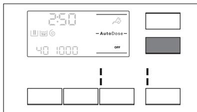
5. Per impostare il dosaggio di base sfiorare i relativi pulsanti serbatoio fino a che sul display non compaiono un dosaggio per bucato predefinito e due frecce sulla parte inferiore del display. Sfiore ripetutamente il pulsante Temp. per regolare il dosaggio verso l'alto e i tasti Centrifuga per regolarlo verso il basso. Lo step minimo è di 1 ml.
