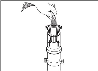
5. Senza la guida del tubo flessibile in plastica, verso il sifone di un lavandino - Fissare il tubo al sifone, e serrarlo con una pinza. Fare riferimento all'immagine.
