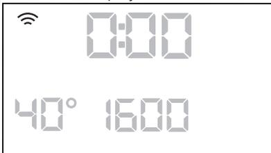
**i** Ogni volta che viene accesa l'apparecchiatura, quest'ultima ci impiega 45 secondi per collegarsi automaticamente alla rete. Quando la spia
