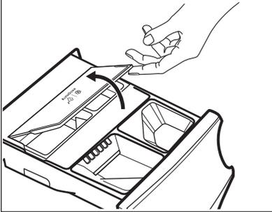
3. Versare delicatamente il detersivo liquido nel serbatoio del detersivo AutoDose
