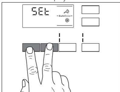
4. Sfiore i relativi tasti carburante per disattivare e attivare la funzione. Sul display compare OFF quando un serbatoio viene disattivato oppure mostra la spia del serbatoio quando è attivato.
