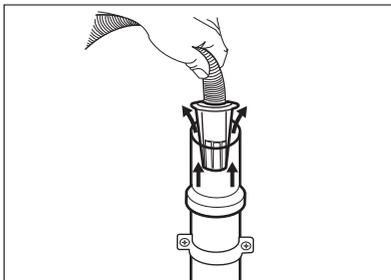
5. **Senza la guida del tubo flessibile in lavandino** - Fissare il tubo al sifone, e serrarlo con una pinza. Fare riferimento all'immagine.
