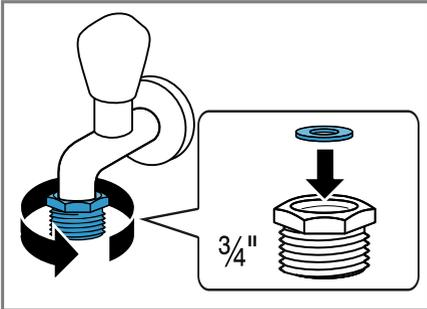
3. Aprire con precauzione il rubinetto dell'acqua e controllare la tenuta dei collegamenti.
