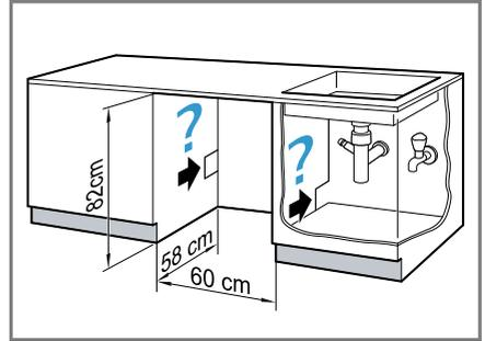
3. Posare il cavo di collegamento, nonché i tubi flessibili di carico e scarico dell'acqua.
