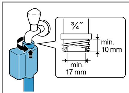
2. Con un rubinetto dell'acqua di 21 mm = 1/2", inizialmente montare un adattatore con rondella.
