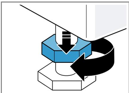
2. Per livellare l'apparecchio, ruotare i piedini dell'apparecchio. Controllare il livellamento dell'apparecchio con una livella a bolla d'aria.
