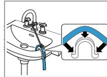
Raccordo di scarico in una condotta di plastica con manicotto in gomma oppure in un pozzetto.
