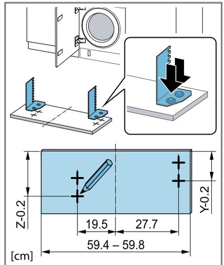
4. **Nota:** Nell'inserimento del pannello dello zoccolo, prestare attenzione a che il timelight non sia visibile se lo zoccolo è tirato in avanti oppure con il pannello del mobile a filo.
