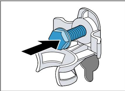
4. Inserire il cavo di collegamento nell'alloggiamento ① e serrare tutte e 4 le viti dei blocchi di trasporto con una chiave inglese da 13 ②.
