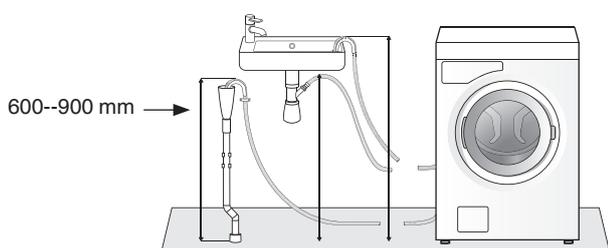
È inoltre possibile collegare la macchina allo scarico tramite un allacciamento a sifone. In tal caso anche il tubo flessibile deve trovarsi ad un'altezza di 600 - 900 mm rispetto al pavimento. Il diametro interno del foro deve essere pari o superiore a 18 mm.
