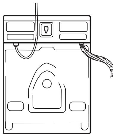
Utilizzare esclusivamente il tubo flessibile fornito con la macchina. Non riutilizzare tubi vecchi o altri tubi flessibili.
