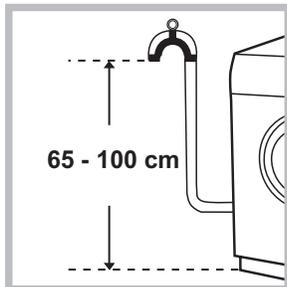
Schließen Sie den Ablaufschlauch ohne ihn dabei abzuknicken an einen geeigneten Abfluss an. Die Mindestabfluhöhe beträgt 65 - 100 cm (gemessen vom Boden), oder hängen Sie diesen mittels des Schlauchhalters gesichert in ein Becken oder Wanne ein;
