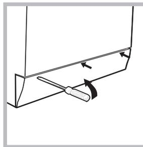
1. Nehmen Sie die Abdeckung (befindlich an der Gerätefront) mit Hilfe eines Schraubenziehers ab (siehe Abbildung);
