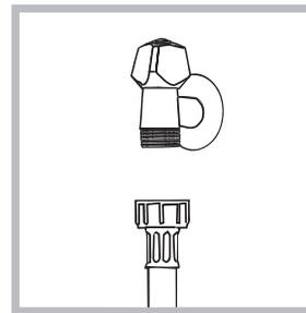
1. Conectar el tubo de tubo enroscándolo a un grifo de agua fría con la boca rosca de 3/4 gas (ver la figura). Antes de conectarlo, haga correr el agua hasta que esté límpida.
