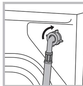
2. Collegare il tubo di alimentazione alla lavabiancheria avvitandolo all'apposita presa d'acqua, nella parte posteriore in alto a destra (vedi figura).
