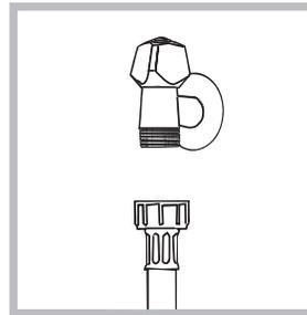
1. Schrauben Sie den Wasserschlauch an einen Kaltwasserhahn mit  $\frac{3}{4}$ -GAS-Gewindeanschluss an (siehe Abb.).
