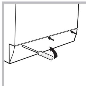
1. tire o painel de cobertura da parte dianteira da máquina de lavar roupa com ajuda de uma chave de fendas (veja a figura);
