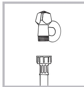
1. Conectar el tubo de tubo enroscándolo a un grifo de agua fría con la boca roscada de 3/4 gas (ver la figura).
