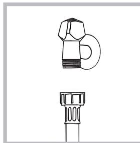
1. Realize a ligação do tubo de alimentação parafusando-o a uma torneira de água fria com bocal de rosca de 3/4 gás (veja a figura). Antes de realizar esta ligação, deixe a água escorrer até estar límpida.
