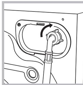
2. Conecte el tubo de alimentación a la lavadora enroscándolo en la toma de agua correspondiente ubicada en la parte posterior derecha (arriba) (ver la figura).
