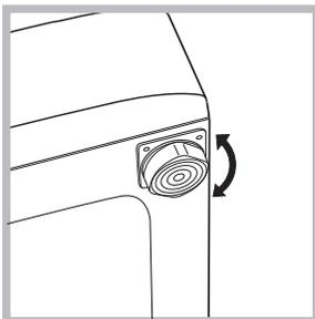
2. Si el piso no está perfectamente horizontal, compense las irregularidades desenroscando o enroscando las patas delanteras (ver la figura); el ángulo de inclinación medido sobre la superficie de trabajo, no debe superar los 2°.
