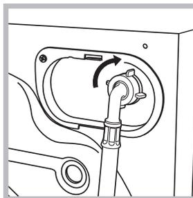
2. Ligue o tubo de alimentação na máquina de lavar roupa atarraxando-o no apropriado fornecimento da água, na parte traseira, em cima à direita (veja a figura).
