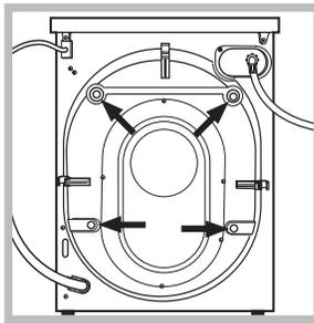
3. Quite los tornillos de protección para el transporte y la arandela de goma con el correspondiente distanciador ubicados en la parte posterior (ver la figura).
