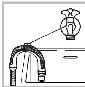
nebo ji uchyťte k okraji umývadla či vany a připevněte vodící držák z příslušenství ke kohoutu (viz obrázek). Volný konec vypouštěcí hadice nesmí zůstat ponořený do vody.
