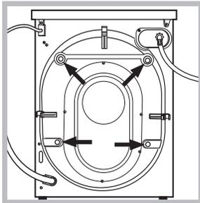
3. Αφαιρέστε τις βίδες προστασίας για τη μεταφορά και το λαστιχάκι με το σχετικό διαχωριστικό, που βρίσκονται στο πίσω μέρος (βλέπε εικόνα).
