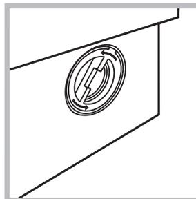
2. odskrutkujte veko otáčaním proti smeru hodinových ručičiek (vid' obrázok): vytečenie malého množstva vody je úplne bežným javom;
