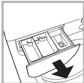
Vytiahnite dávkovač jeho nadvihnutím a vytiahnutím smerom von (vid' obrázok). Dávkovač umyte pod prúdom vody; toto čistenie je potrebné vykonávať pravidelne.
