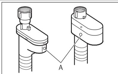
Il tubo di carico dell'acqua dispone di un dispositivo Acqua-stop. Questo dispositivo impedisce le perdite d'acqua nel tubo da ascrivere al naturale invecchiamento del tubo. Il settore rosso nella finestra «A» mostra questo problema. In tal caso, chiudere il rubinetto dell'acqua e contattare il centro di assistenza per sostituire il tubo.
