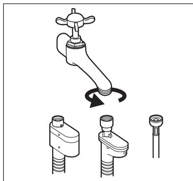
2. Collegare il tubo di carico dell'acqua a un rubinetto dell'acqua fredda con filettatura 3/4".
