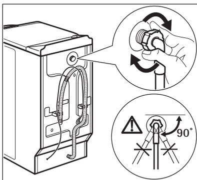
4. Togliere il tubo di carico dell'acqua situato dietro l'apparecchiatura.
