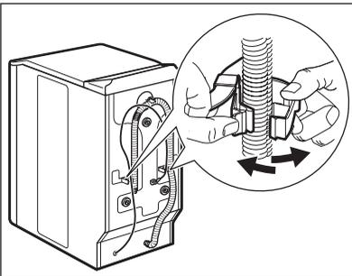
11. Staccare il cavo di alimentazione ed il tubo di scarico dagli appositi supporti.
